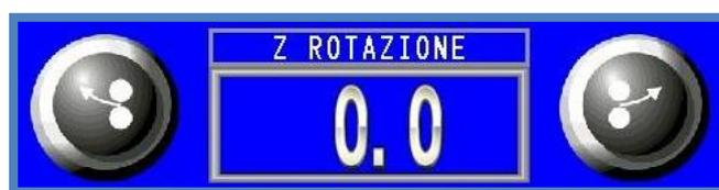
Vengono gestiti con un encoder incrementale. La quota viene visualizzata a schermo in un riquadro dedicato. In manuale la posizione assoluta può essere resettata selezionando il visualizzatore numerico. Questa operazione è svolta a discrezione dell'operatore.
