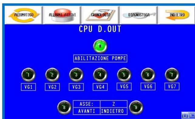
Mostra le uscite digitali della CPU. (Menù allarmi/Diagnostica/Uscite/CPU D. OUT)
