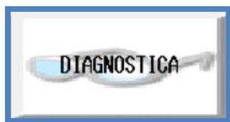
Accede al sottomenù di diagnostica. In esso sono contenute delle pagine per verificare lo stato attuale della macchina. Inoltre vengono mostrati tutti gli ingressi e le uscite del PLC con specificato la relativa funzione. Velocizza la diagnosi e la risoluzione di eventuali malfunzionamenti della macchina.
