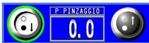
Vengono gestiti con un trasduttore di pressione 4-20mA. La quota viene visualizzata a schermo in un riquadro dedicato. Non necessita di alcun tipo di reset per essere operativo. In automatico quando viene richiesto di raggiungere una quota l'asse avanza fino al raggiungimento della pressione desiderata, quando viene richiesto di raggiungere la quota **0** l'asse indietreggia fino a raggiungere il sensore di prossimità della posizione di riposo.
