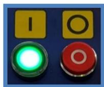
Sono i pulsanti per l'avvio e l'arresto delle pompe. Il **pulsante verde** attiva le pompe. La **spia verde** indica quando il motore delle pompe idrauliche è attivo. Il **pulsante rosso** ferma le pompe.
