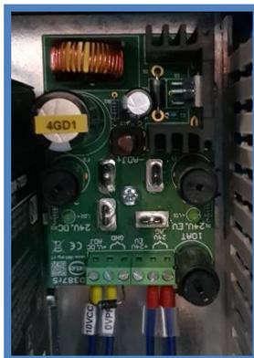
Qualora siano presenti dei sensori analogici, sarà presente un alimentatore stabilizzato per alimentare i sensori analogici e garantirne la precisione necessaria.
