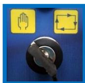
Il **selettore** a chiave nel pulpito determina la modalità operativa della macchina. Ruotare il selettore con l'apposita chiave inserita per variare la modalità desiderata. L'interfaccia utente segnala la modalità operativa attuale cambiando un'icona del menù. Essa è ubicata nell'angolo superiore sinistro dello schermo.
