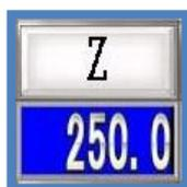
Dopo essere stato selezionato il pulsante di un asse sarà illuminato in bianco. Esso potrà esser movimentato in manuale tramite il **joystick** universale o il **bimanuale**.
