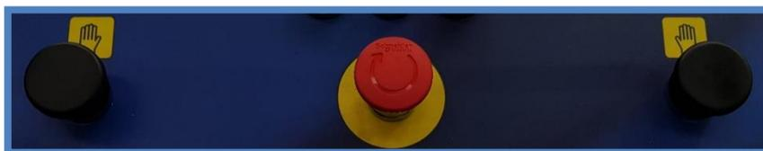
I pulsanti neri che si trovano sul pulpito di comando attivano il modulo **bimanuale**. Vanno premuti in contemporanea affinché la macchina possa eseguire un'azione. Tale modulo serve per muovere in sicurezza un asse in manuale o per eseguire una ricetta in automatico.
