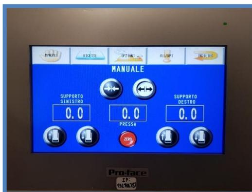
L'interfaccia utente è gestita da un pannello della Pro-face. Viene fornito con un dispositivo di archiviazione di massa. Esso viene utilizzato per archiviare le ricette e la cronologia dei messaggi diagnostica. È fissata nella parte posteriore dello schermo e non è accessibile fisicamente dall'esterno. Risulta raggiungibile virtualmente dall'esterno quando il DLC4.0 viene collegato alla rete aziendale.
